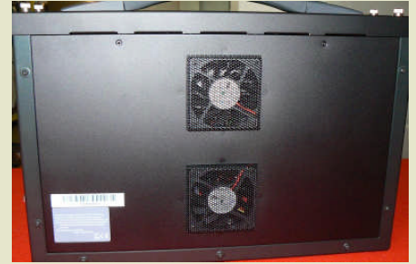
Ventilation forcée pour les cartes d'extension et le système
